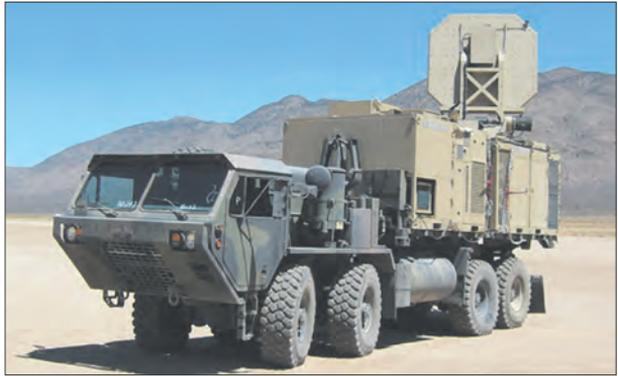
*Мобильная установка СВЧ-оружия ADS, смонтированная на армейском автомобиле высокой проходимости. Кабина имеет легкое бронирование*
