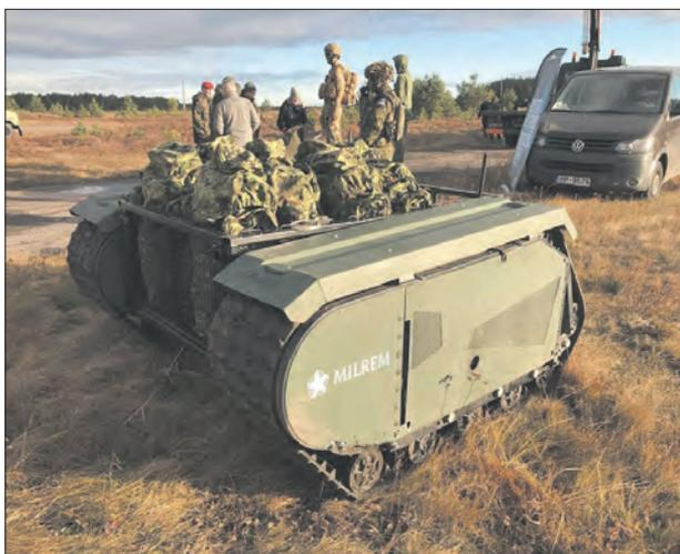
*ДУМ «Темис» может нести комплекты вооружения и применяться в качестве машины обеспечения*
