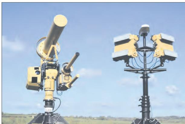
**Комплекс противодействия БПЛА «Аудс» в боевом положении**
