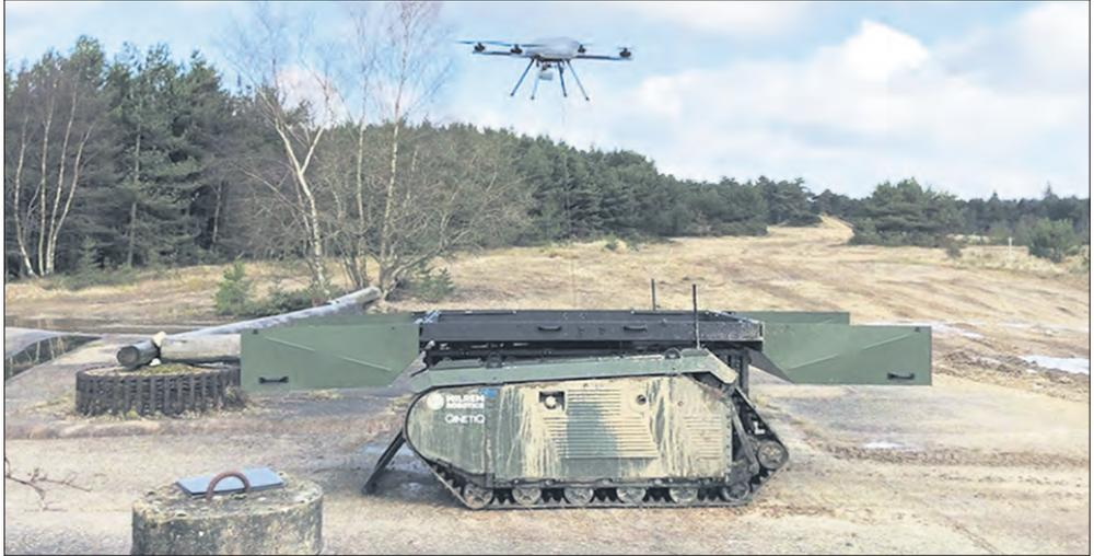
*Модификацией разведывательной версии машины является «Обсервер». Он характеризуется наличием на борту платформы для пуска беспилотного летательного аппарата с несколькими вариантами полезной нагрузки*
