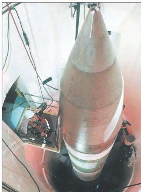
*МБР «Минитмэн-3» в шахтной пусковой установке*
