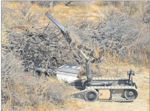
*Для сбора сведений об искусственных препятствиях на пути движения войск, а также обезвреживания и уничтожения взрывоопасных предметов военнослужащие инженерных подразделений СВ США задействуют робототехнические комплексы*
